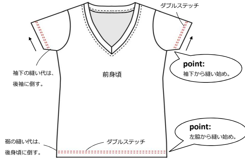
14. 身頃の裾と袖口を二つ折りにし、ダブルステッチをかける。
