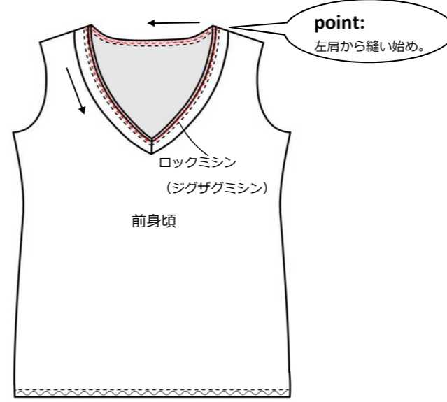
8. 衿切替の縫い代にロックミシン (ジグザグミシン) をかける。
